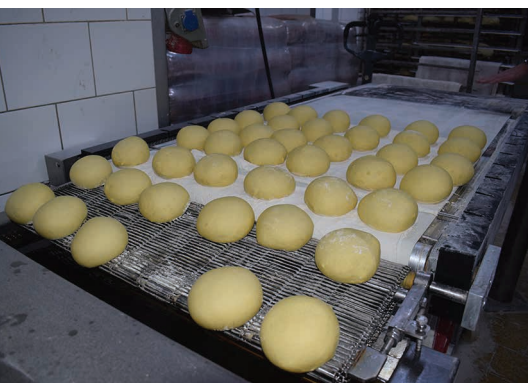
Za chwilę pączki trafią do smaźalnika, gdzie w temperaturze 180-200 °C zostaną usmażone w ciągu 8 minut
