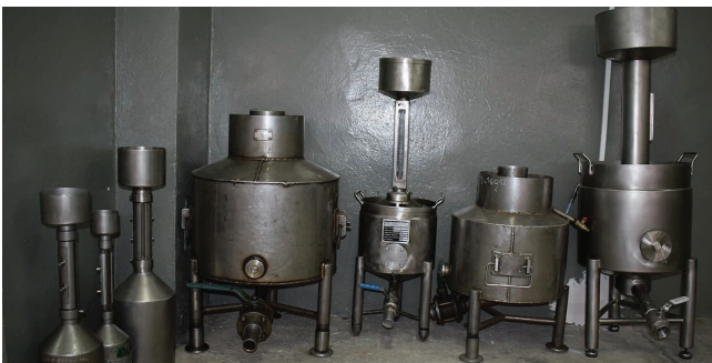
Kolby pomiarowe do badań dystrybutorów na stacjach paliw
