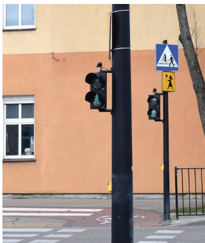
Suwalska sygnalizacja świetlna ma zamontowany dźwiękowy alarm ułatwiający poruszanie się osobom niewidomym
