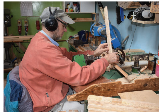
Jarosław Korenkiewicz obsługuje wiertarkę do opraw szczotek
